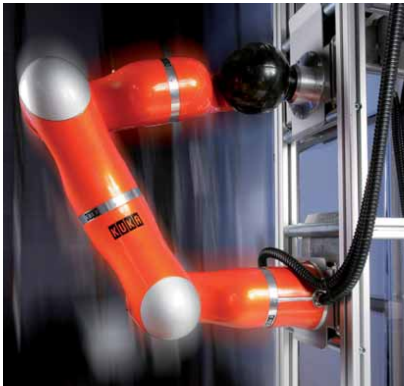
Per la robotica di servizio Kuka ha sviluppato il Light Weight Robot.
