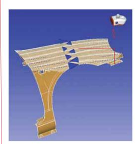
Una macro scansione viene creata automaticamente utilizzando la simulazione della nuvola di punti.
