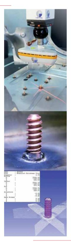
Dalla digitalizzazione completa della geometria ad "albero di Natale" i produttori di automobili verificano la posizione di saldatura in modo veloce e automatizzato.
