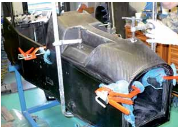
4. L'incollaggio del telaio è fatto attraverso adesivo strutturale epossidico. Le giunzioni sono state messe a punto in collaborazione con Henkel.
