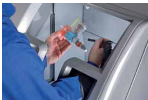
La stampante ZPrinter 450 della Z Corporation. I modelli vengono stampati direttamente da file CAD 3D SolidWorks.
