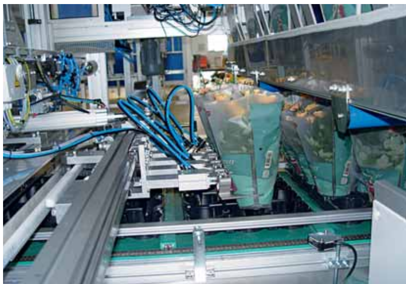
Visser combina i moduli macchina standard in impianti personalizzati sulle esigenze degli utilizzatori: handling e confezionamento fiori.
