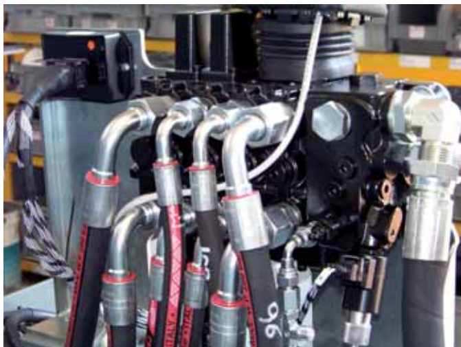
Il distributore HDS34 di Bucher Hydraulics montato sul sollevatore telescopico della linea Agri prodotta da Dieci.
