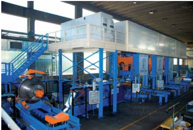
L'impianto realizzato da Cavenaghi & Ridolfi con la collaborazione di Bosch Rexroth è una linea di produzione automatica per componenti di elettrodomestici alimentato da coil.
