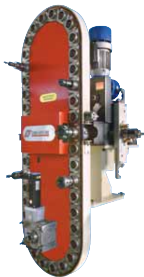
Cambia utensile con magazzino ad anello tipo CTA 40 HS.
