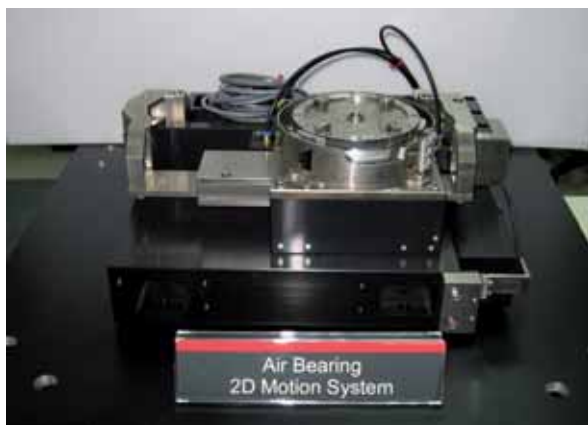
Sistema di movimentazione per la fabbricazione di apparati elettronici costruito utilizzando cuscinetti ad aria.
