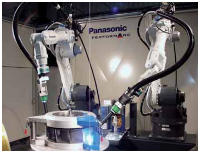
Tawers di Panasonic, il sistema integrato per la saldatura ad arco robotizzata.
