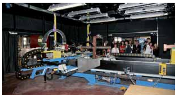
8. Magnetoscopio a banco realizzato per Alitalia.
