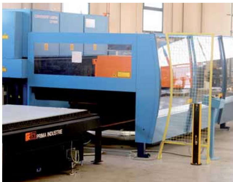
La macchina per il taglio Platino 1530 di Prima Industrie equipaggiata con il laser CP 4000 W.
