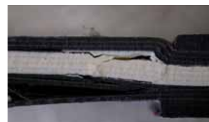
4. Macrografia del sandwich: delaminazione e debonding delle pelli e rottura del core.
