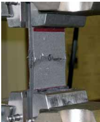
5. Rottura di provini nelle prove di open hole compression: a) Cfrp, b) sandwich.
