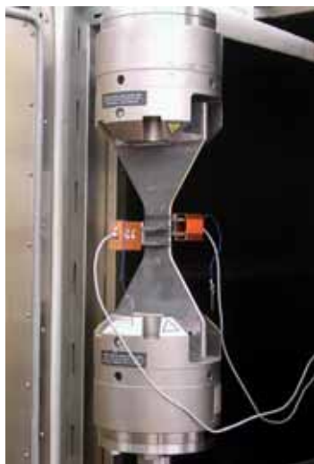
10. Set up di prova (a) e curva stress-strain di trazione su sandwich non forato in condizioni di hot/wet (b).
