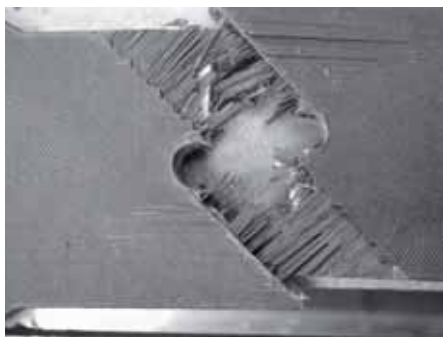
7. Vista in piano della rottura a trazione del sandwich Syncore (a) e vista laterale (b).
