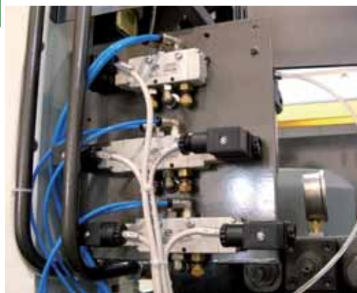
Gruppo valvole per applicazione speciale su macchina speciale (movimentazione pinze di carico/scarico).
