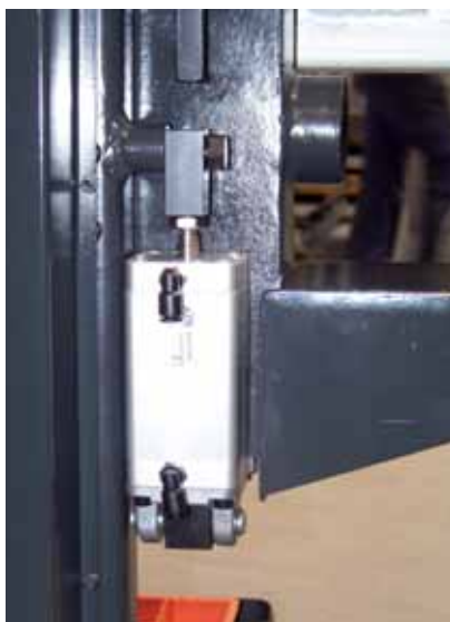
Cilindro per movimentazione gruppo utensili sega circolare per pacchi impiallacciatura.
