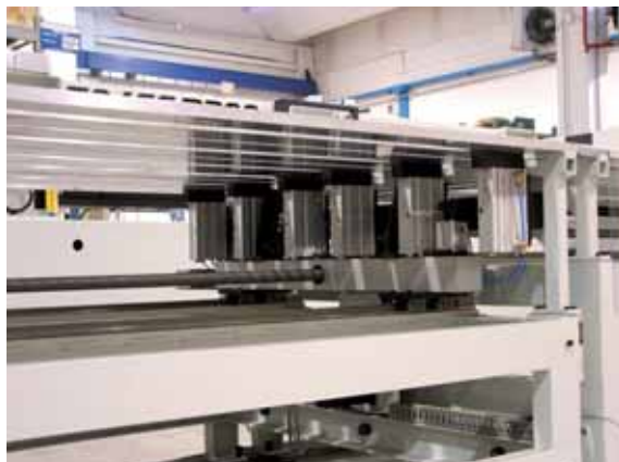
Pinze per il posizionamento dei pacchi di impiallacciatura.
