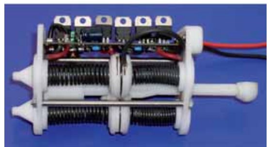
9. Attuatore lineare a memoria di forma per applicazioni automobilistiche.
