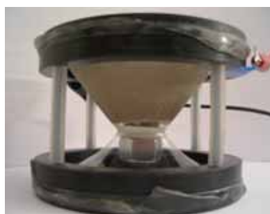
12. Attuatore lineare a doppio tronco di cono realizzato con pellicola polimerica elettroattiva.
