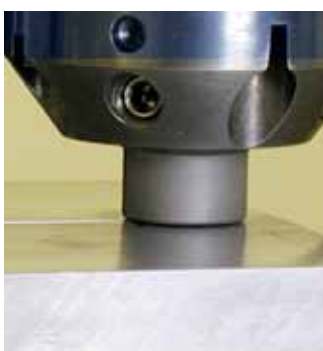
FSW-Machine. Fonte: Lockheed Martin.
