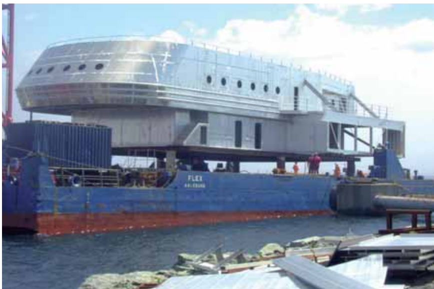
Esempio di una struttura saldata FSW per sovrastruttura di una nave da crociera. Fonte: Marine Aluminium Norway.
