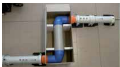
1. Silenziatore sotto verifica e relativo tubo di misura.
