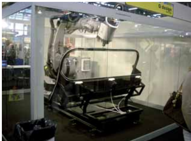
Il robot antropomorfo Kuka per la fresatura e il taglio ad alta velocità di materiale composito, presentato da QDesign.
