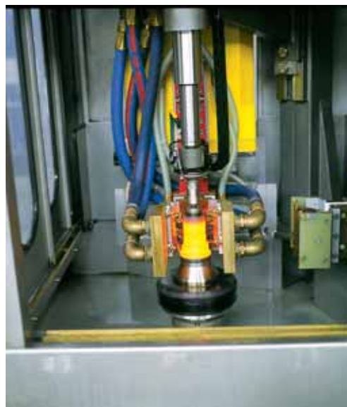
Operazioni di tempra di un giunto per autotreno.
