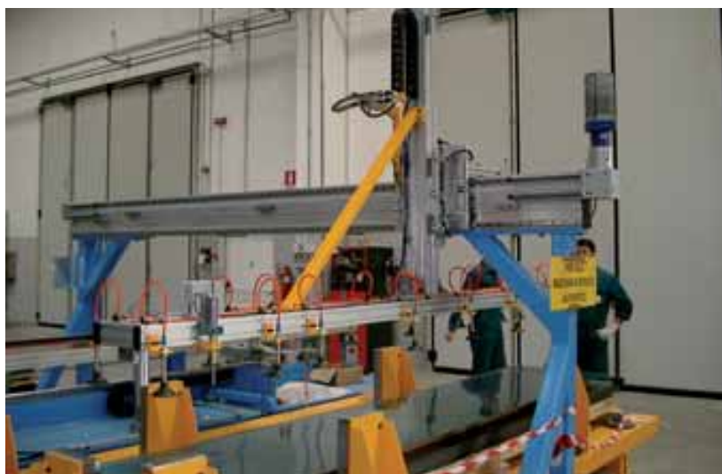
Modulo MLT400 con guide e rotelle in acciaio temprate e trasmissione a cinghia dentata.
