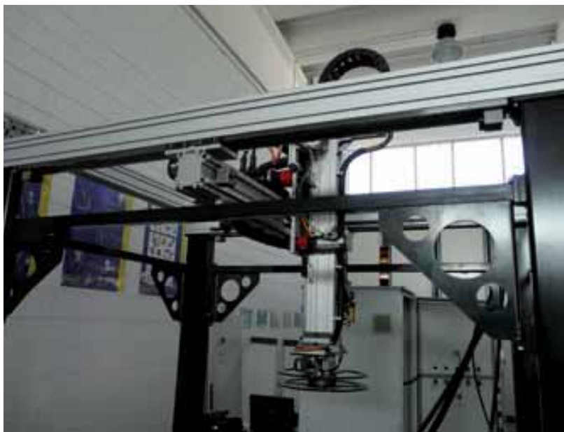
Portale a tre assi per impianto di verniciatura ad alta pressione composto da nr. 5 moduli standard.
