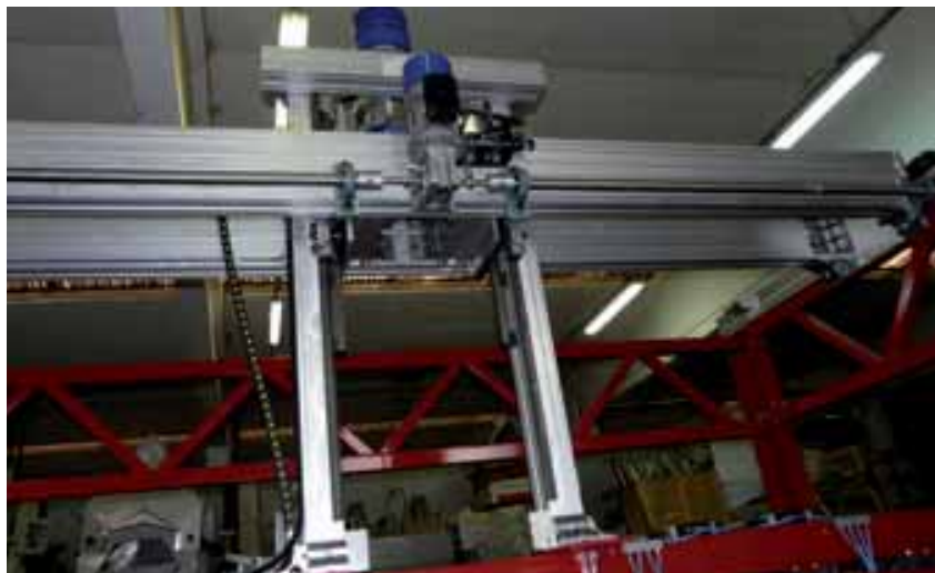
Portale TMT 'customizzato' utilizzato per la movimentazione di laterizi. Carico utile 1.000 kg. Realizzato con profili della gamma Speedy Rail e rotaie Steel Rail.
