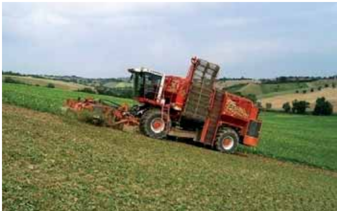
1. Scavabietole semovente esafile in fase di lavoro su terreno collinare.
