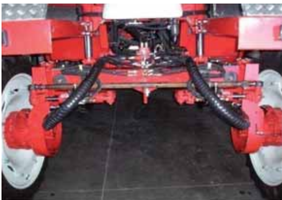
5. Assale posteriore con carreggiata variabile di un irroratore semovente.
