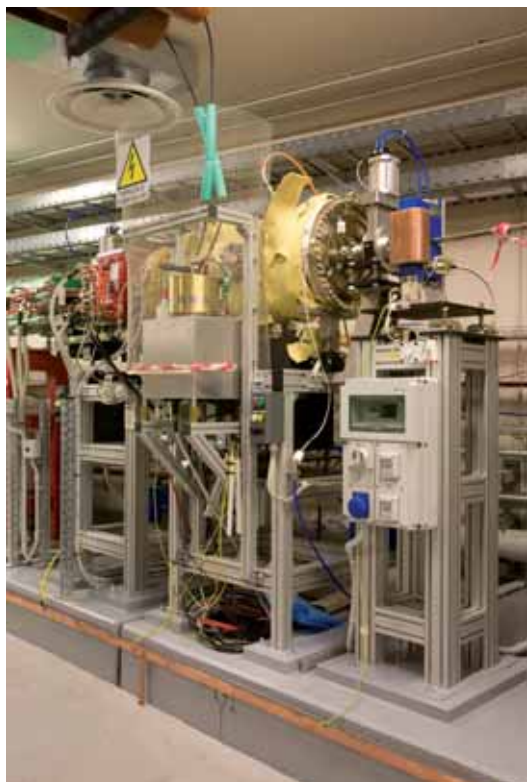
4. La struttura di profili di alluminio Bosch Rexroth impiegata nel Booster di Elettra.
