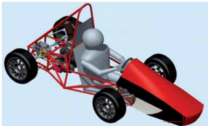
4. Progetto per una automobile da competizione formula SAE o Student.
