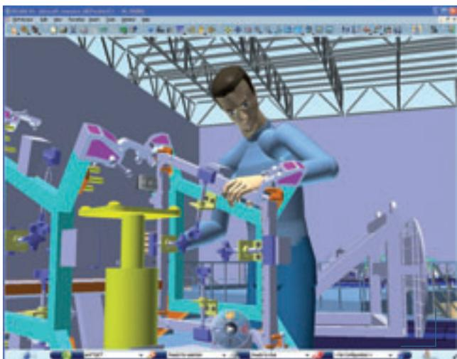
**Delmia V6** permette di simulare i movimenti degli addetti a una linea di montaggio.
