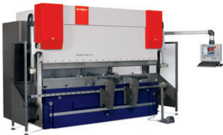
La pressa piegatrice della serie Beyeler Xpert, che garantisce la massima precisione di ripetizione.
