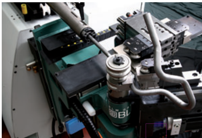
Il sistema di curvatura elettrico Dynamo-ELE LR 150, destro e sinistro in processo con carico e scarico integrato.
