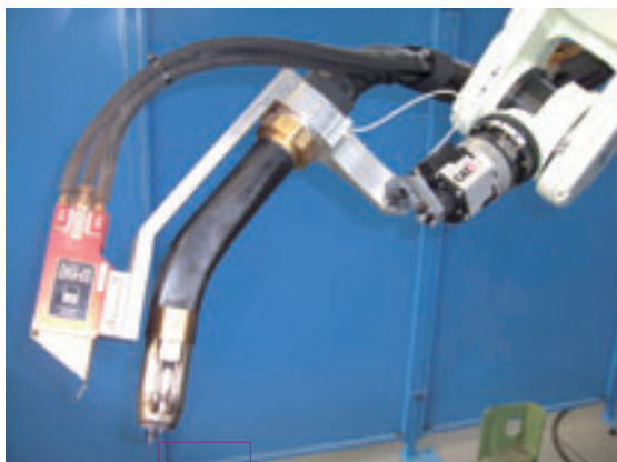
Doppio filo e laser insieme in un'applicazione di saldatura.
