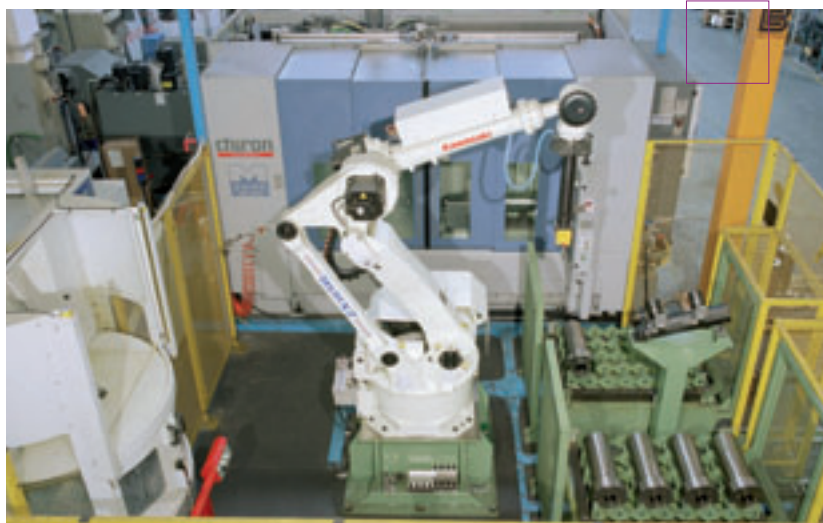
Per l'asservimento di macchine utensili, la disponibilità dei robot Kawasaki permette di manipolare pezzi sia di piccola che grossa taglia.
