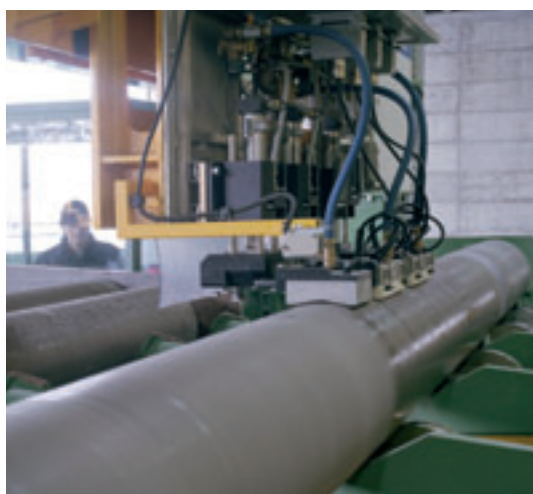
Sistema automatizzato per il controllo a ultrasuoni delle billette.
