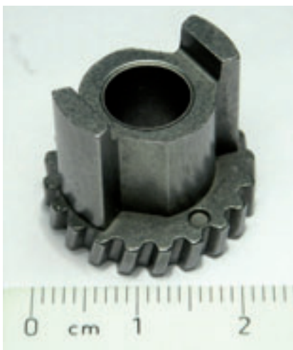
11. Ingranaggio con mozzo per sollevavetri per automobile.
