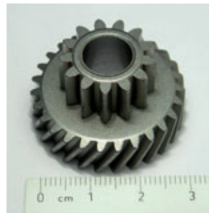
9. Doppio ingranaggio, elicoidale e a denti diritti, per motosega.
