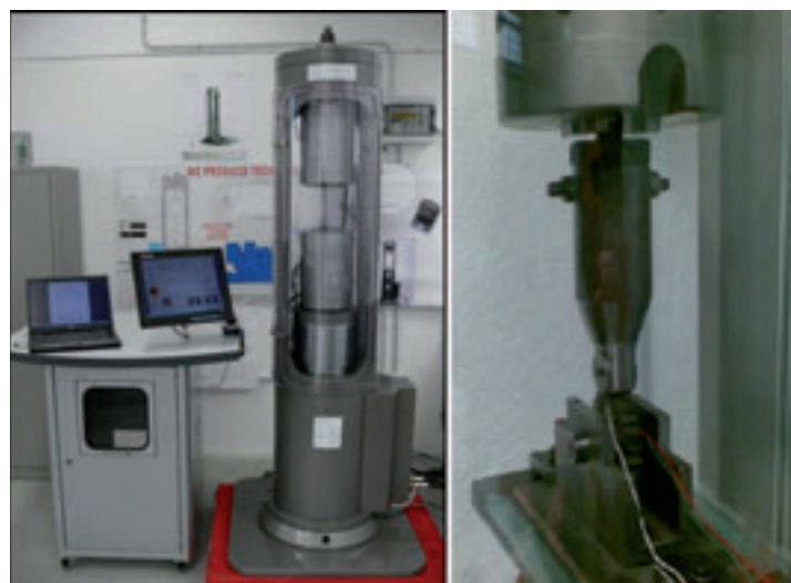
7. Macchina di prova BRT VT250 e attrezzatura di sostegno della ruota dentata.
