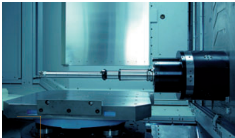
Il centro di lavoro Makino a92 può utilizzare utensili fino a 900 mm di lunghezza che permettono di eseguire barenature e lavorazione di fori di elevata lunghezza senza utilizzare la rotazione della tavola.
