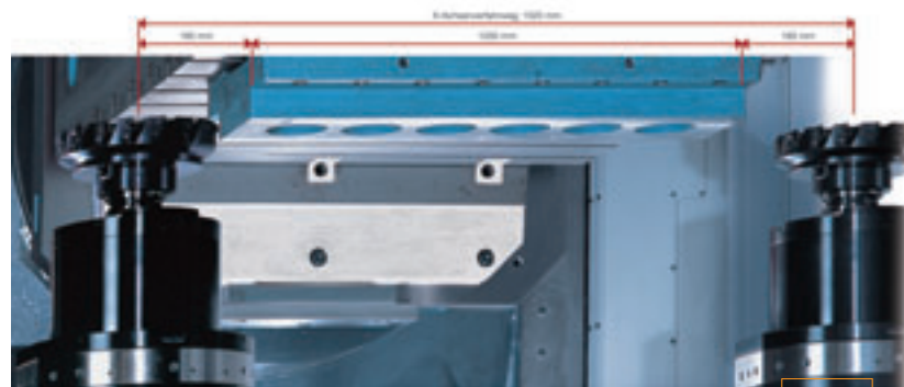
Lavorazione della faccia di accoppiamento tra blocco e testa di un motore diesel 6 cilindri. Si possono usare frese del diametro di 320 mm per operazioni di sgrossatura e finitura e mole per la finitura superficiale.
