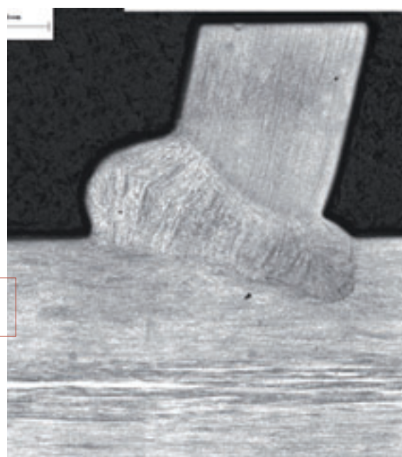
Figura 5. Macrografia del giunto LB GMAW (UNS S32205, v=1,20 mm/min, Q=0,77 , ER2209, attacco elettrolitico con acido osalico).
