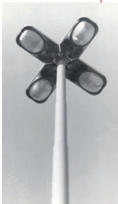
**Lampione stradale.** Questo lampione stradale progettato nel 1970 da Joe Colombo e prodotto da POLLICE nel 1971, grazie a uno speciale tipo di innesto, poteva essere usato singolarmente oppure unito ad uno o più elementi disposti a raggiera. L'innovazione consisteva nell'aggancio del vetro al corpo inferiore per poter cambiare la lampada senza rischi di rottura del vetro. Ne restano esempi di utilizzo alla Fiera Milano City.
