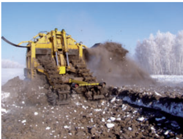
I. L'unità denominata Mprg-1 rimuove gli strati superiori di humus, con un profondità di circa 30 cm.
