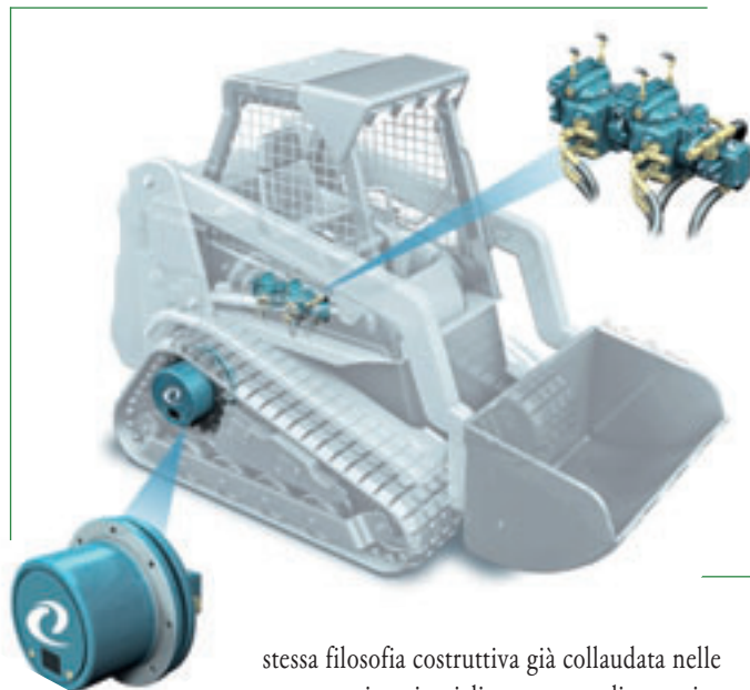
Trasmissione per caricatore compatto composta da due riduttori cingolo serie Pgr 802 e da una pompa V 450.
