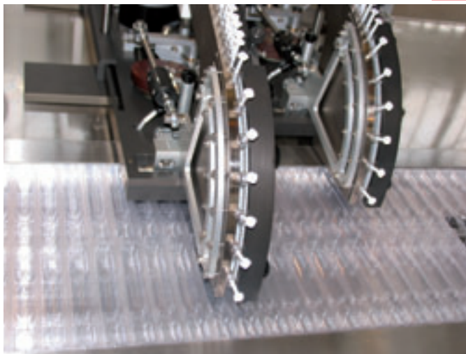
Fase di inserimento delle siringhe nel blister con una macchina realizzata da Partena.
