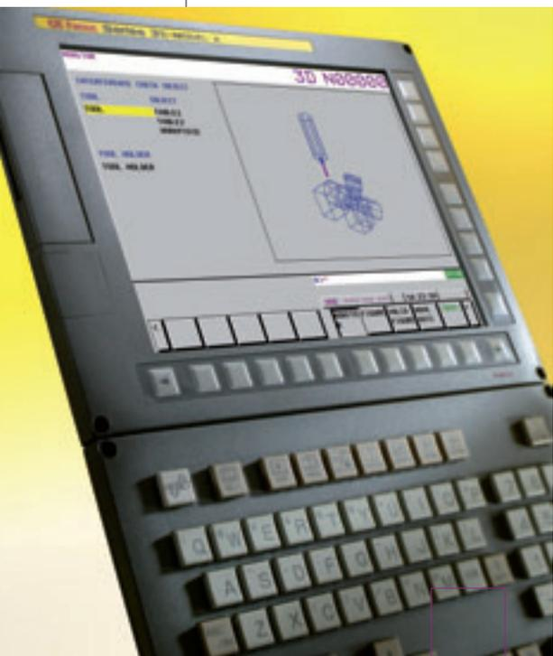
**Il controllo delle collisioni viene fatto in un ambiente grafico 3D, delimitando le aree proibite per mezzo di figure geometriche elementari (parallelepipedi, cilindri, sfere, piani).**
