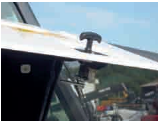
Quando la serratura viene bloccata dalla chiave, la camma effettua una pressione di 300 N sul pannello.
