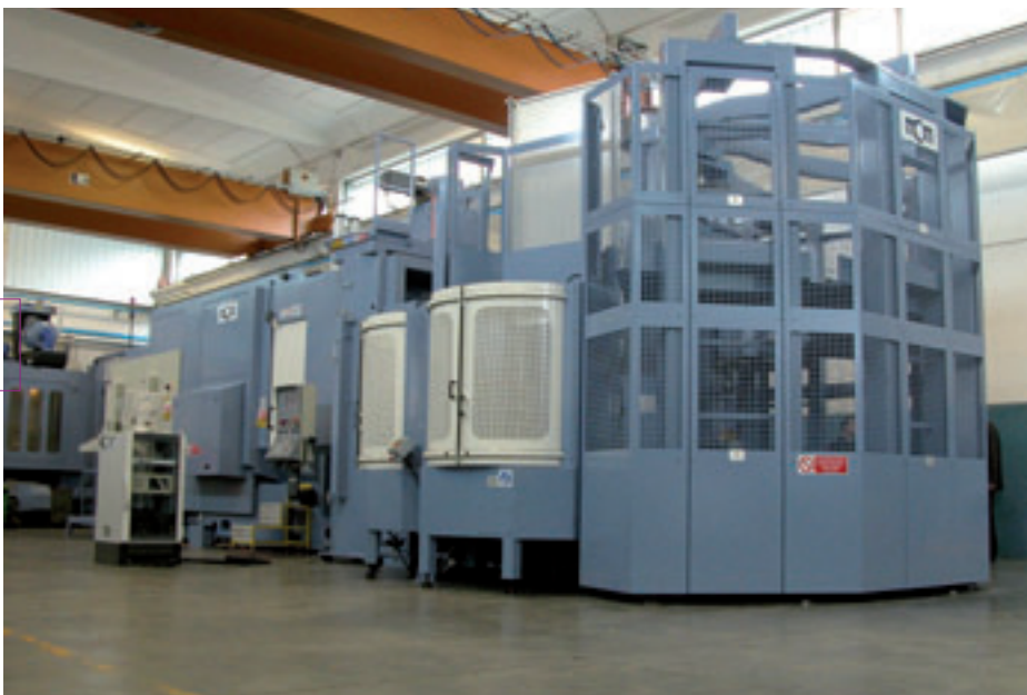
L'MP 16 della serie Tank dei Multitasking per eseguire lavorazioni di fresatura, tornitura e rettificazione in un'unica soluzione.
