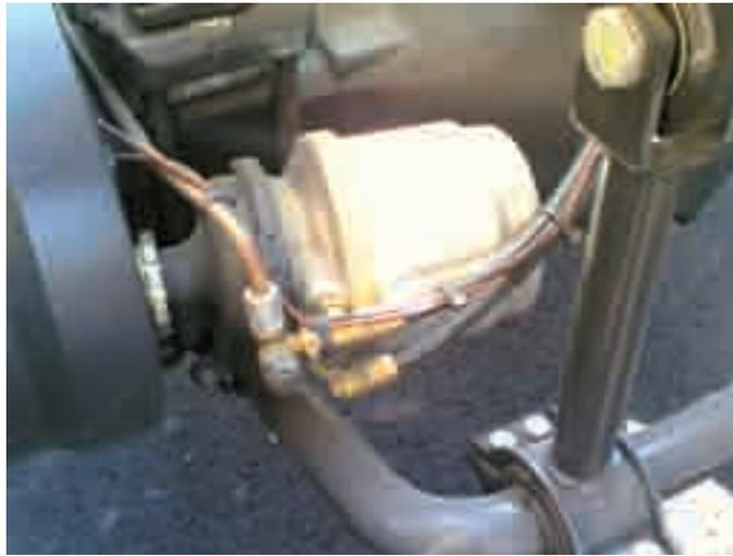
**Cilindro freno con raccordi in ottone per l'azionamento pneumatico dei freni.**
