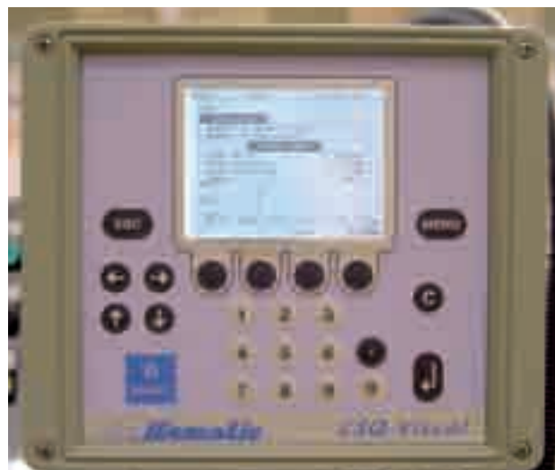
2 e 3. I Csq-Visual di Alfamatic, installati a bordo macchina, determinano in tempo reale una serie di parametri: altezza del pezzo, profondità di pressatura, curva forza-spostamento.
