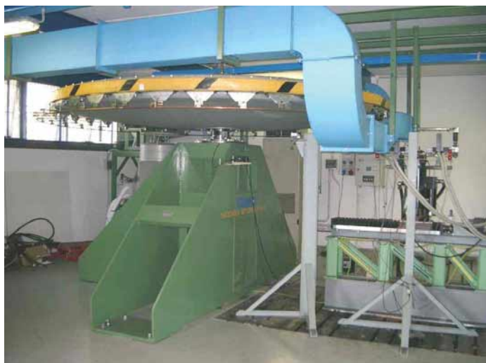
3. Immagine della macchina di prova captazione e striscianti, installata presso il laboratorio C4 del Dipartimento di Meccanica.
