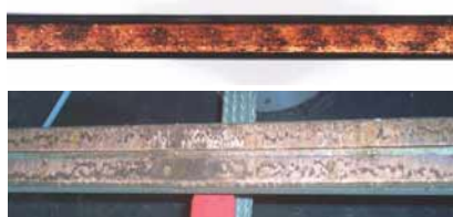
2. Aspetto della superficie del filo di contatto (in alto) e dello strisciante in rame (in basso) in conseguenza delle condizioni di esercizio.
