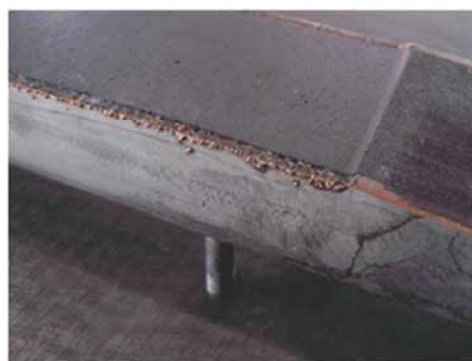
10. Fermo immagine durante la ripresa di una prova con strisciante in rame a 165 km/h e 500 A.
