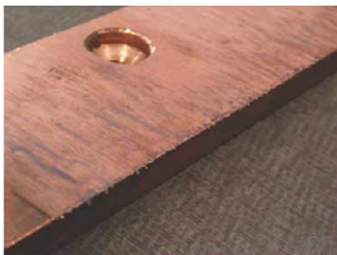
11. Esempi di striscianti a termine prova. Strisciante in rame (a sinistra), strisciante tipo kasperowksi (grafite e rame, a destra).
