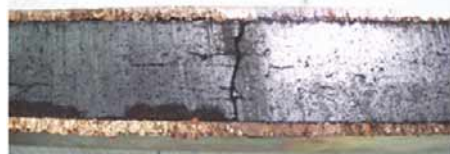
12. Esempi di striscianti a termine prova. Strisciante grafite (sopra), strisciante tipo kasperowksi (grafite e rame, sotto). In questo caso si evidenziano rotture e fessurazioni che interessano l'intera matrice di grafite.
