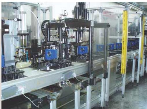
**Linea per il montaggio** automatizzato dei riduttori a vite senza fine.
