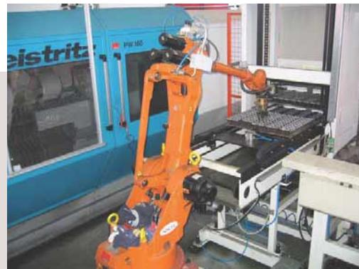
**Robot per carico e scarico pezzi.**
