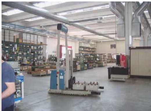
**Carrello laser guidato** (LGV) rifornimento magazzino in e out.
