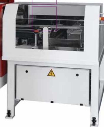
avvenire in 15 s. La precisione di posizionamento è di +/- 0,1 mm. L'azionamento dell'asse Y è regolato dal CN e quello Z da un moto sinusoidale comandato pneumaticamente.
