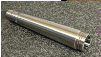
**Mandrino idrodinamico della testa porta pezzo della S36; a sinistra, dopo la tornitura e a destra, dopo essere stato sottoposto alle operazioni di finitura.**
