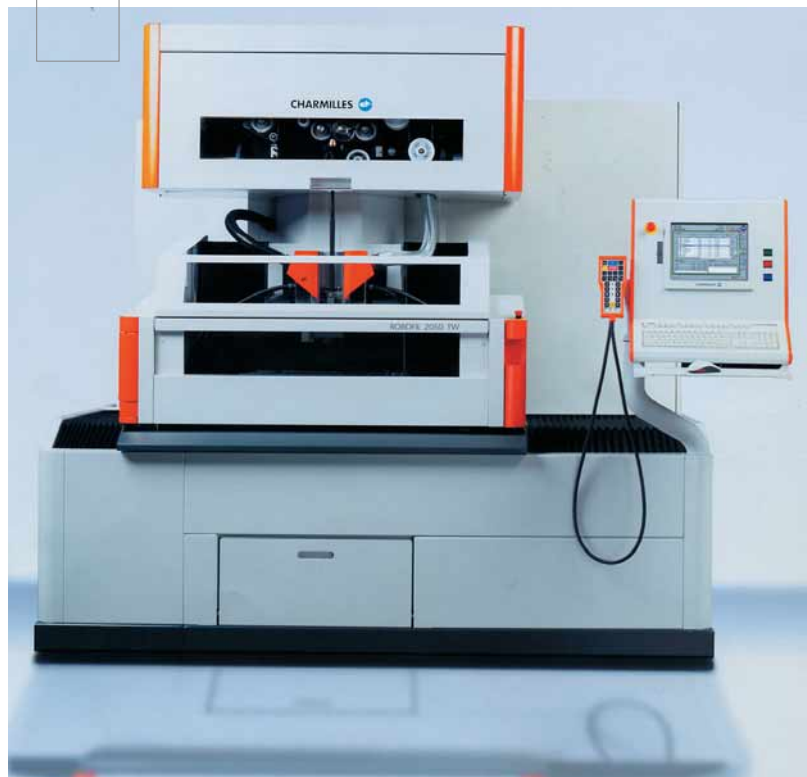
Robofil 2050 TW con console mobile per consentire di comandare e di controllare la macchina il più vicino possibile alla zona di lavoro.
