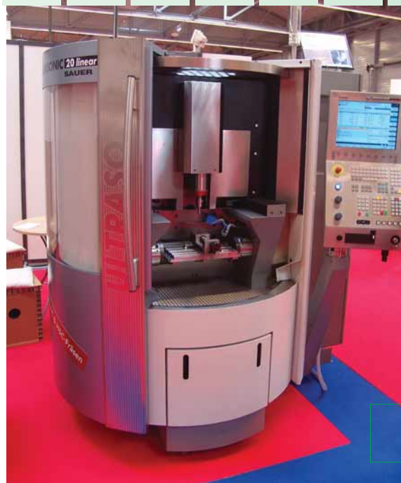
DMG Sauer DMC20 Linear Ultrasonic, fresatrice con finitura a ultrasuoni.
