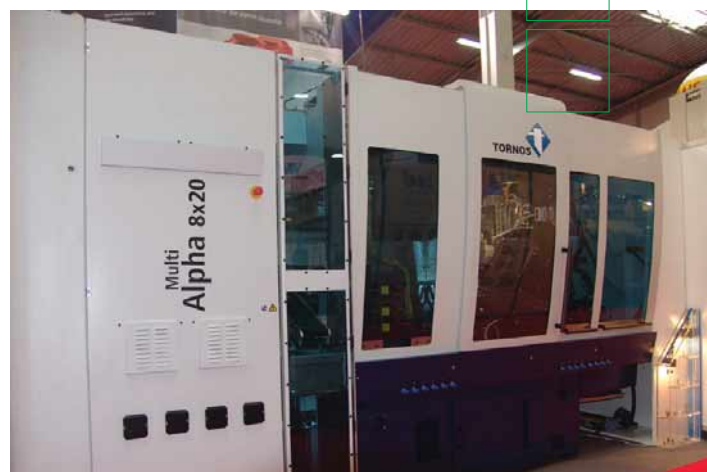
Tornio multimandrino MultiAlpha 20X8 di Tornos.
