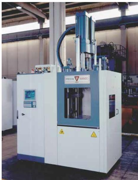
**Opera Advantage 260,** pressa a iniezione verticale da 260 t per elastomeri.
