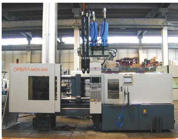
**Opera H/OR 300,** pressa a iniezione orizzontale da 300 t per elastomeri, specifica per la produzione di O-ring.
