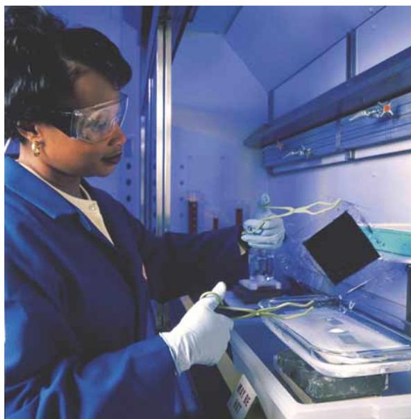
**DuPont Gen IV (DuPont Fuel Cells), una nuova tecnologia per produrre componenti Mea (Membrane Electrode Assemblies, assemblaggi di elettrodi a membrana).** Questi componenti permettono di realizzare pile a combustibile diretto a metanolo (Dmfc, direct methanol fuel cell) con migliori prestazioni in termini di quantità e durata; un'energia più pulita, economica e sostenibile.
