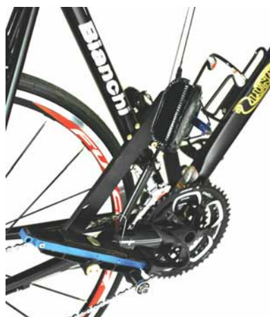
3. Pedale e contropedivella dotata di un appoggio tibiale.
