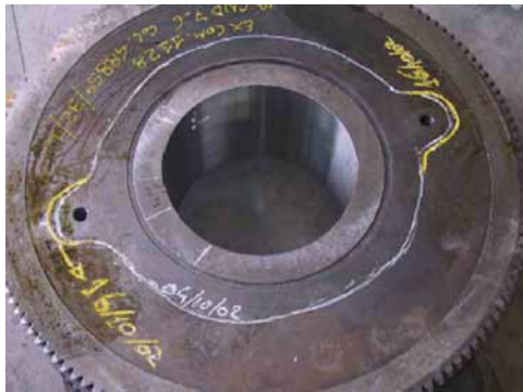
2. Cricca radiale nel componente evidenziata dalla linea bianca.
